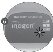
6. Cuando la luz verde se ilumina, la batería está completamente cargada.
